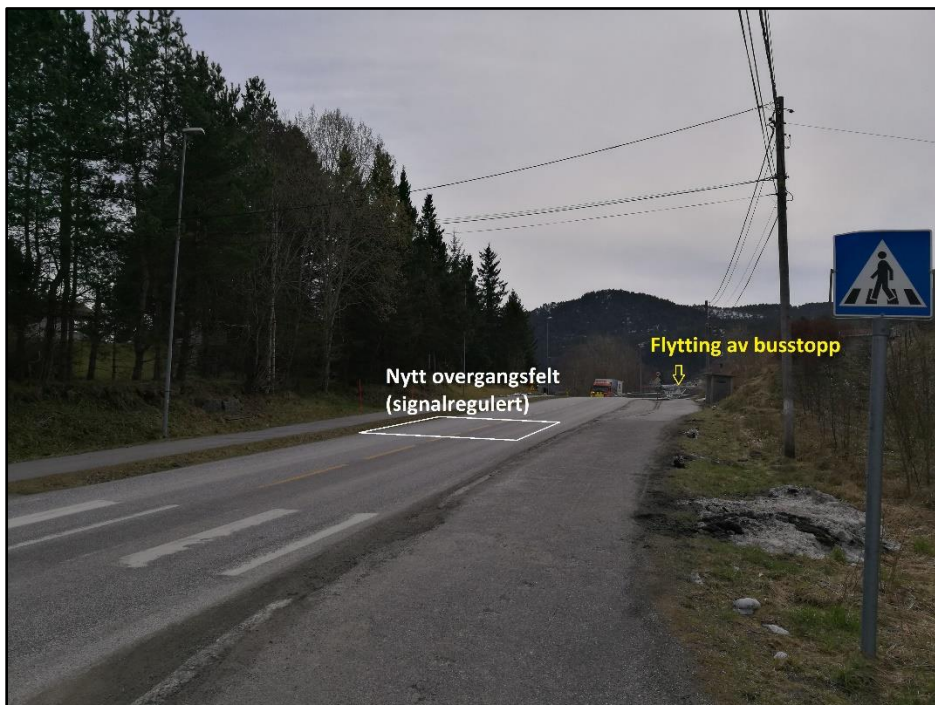
Bilde 5.1.8 – Illustrasjon av endra overgangsfelt (signalregulert) og busstopp på Fv 657, syd for Rørstadkrysset
